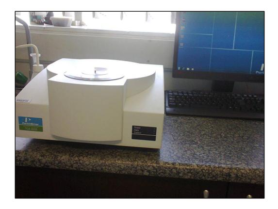
**Figure 4:** Thermogravimetric Analyser (TGA)
